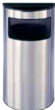
AL 402 I SE Acero inox 0,8mm. Cenicero-papelerá. Recogecolillas epoxi negro. Ganchos interiores para bolsa. Aro inferior PVC. Capacidad 74 litros. ø 50 x 95 cm.
